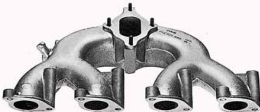
Ansaugrohr mit größerem Querschnitt
