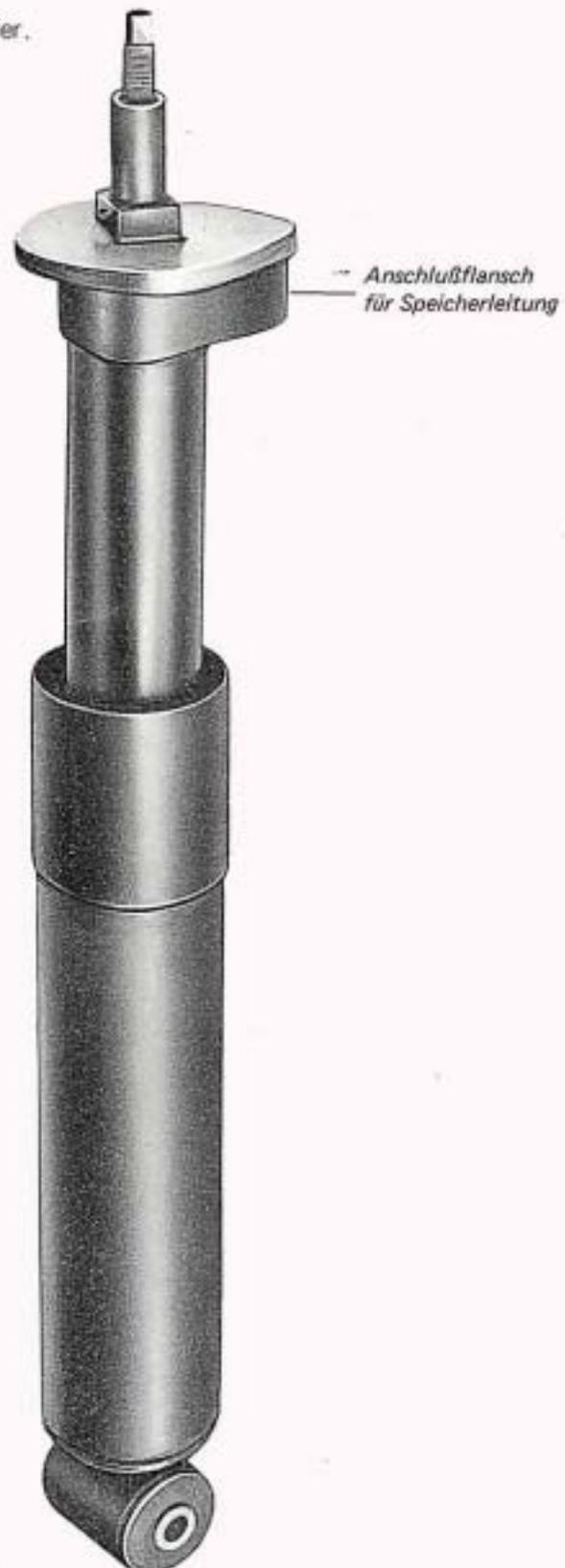
Der mechanische Aufbau des Federzylinders entspricht im wesentlichen eines herkömmlichen Stoßdämpfers.
