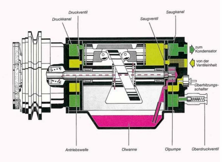
Bei jeder Umdrehung der Antriebswelle bewegt die Taumelscheibe jeden Doppelkolben einmal hin und zurück. Dabei saugt jeder Doppelkolben über das Saugventil Kältemitteldampf in den jeweiligen Zylinder. Bei einer Motordrehzahl über 2000/min. und einer Umgebungstemperatur von 20°C wird der Kältemitteldampf auf einen Druck von ca. 14 bar verdichtet und über das Druckventil in den Druckkanal gefördert.
