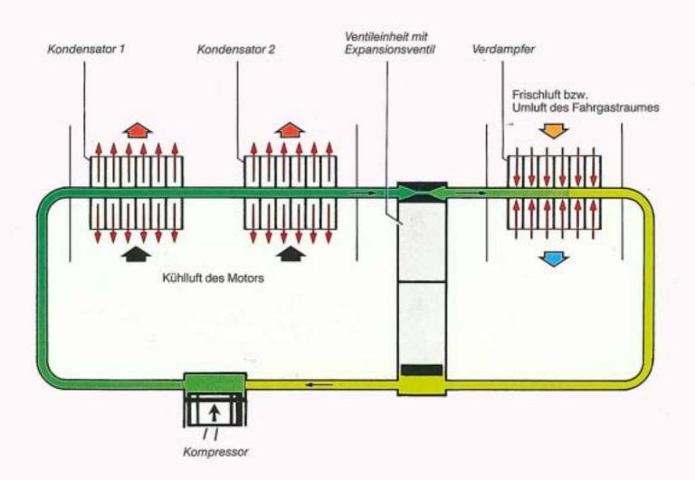
Das entspannte Kältemittel nimmt über den Verdampfer
