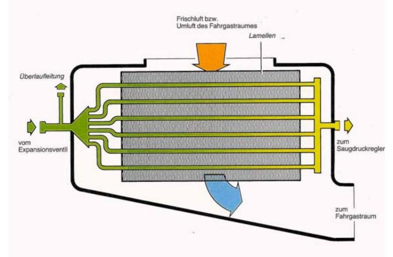
Das entspannte Kältemittel tritt unter einem Druck von ca. 2,2bar und einer Temperatur von ca. 0°C in den Verdampfer ein, strömt durch die Rohrschlangen und nimmt dabei über die Lamellen Wärme von der Frischluft bzw. Umluft des Fahrgastraumes auf. Das flüssige Kältemittel verdampft.
