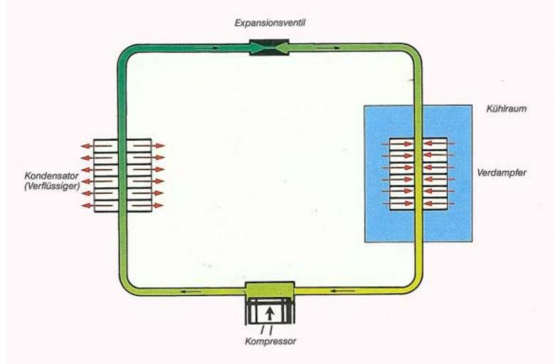
Das entspannte Kältemittel nimmt über den Verdampfer
