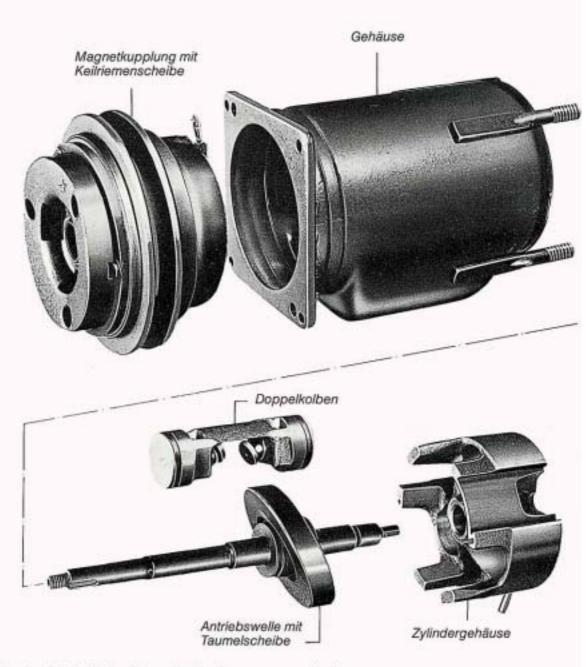
Die wesentlichen Bauteile des Dreizylinder-Doppelkolbenkompressors sind:
