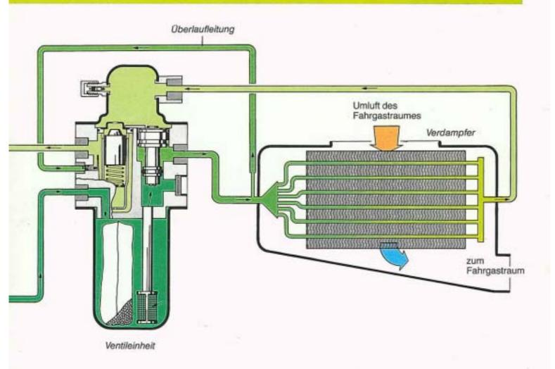
Das flüssige Kältemittel strömt in den Flüssigkeitsbehälter und über das Filter weiter zum Expansionsventil. Das Expansionsventil versprüht je nach Temperatur des zurückströmenden Kältemitteldampfes –
