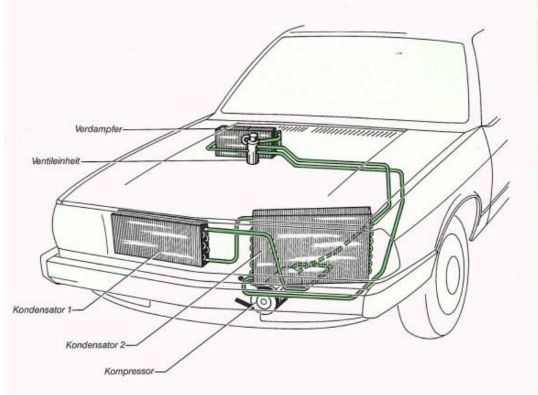
Die Klimaanlage im Audi 100 besteht aus folgenden Aggregaten:
