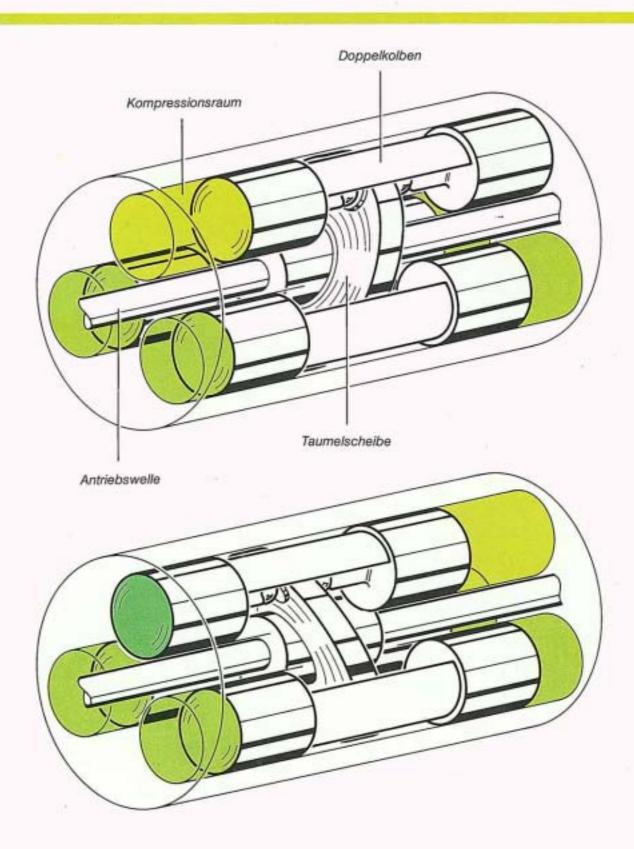
Die drei Zylinder sind jeweils um 120° versetzt angeordnet. In jedem Zylinder arbeitet ein Doppelkolben. Das ergibt insgesamt sechs Kompressionsräume.
