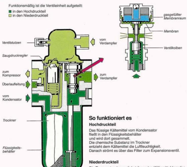
Die Temperatur des zurückströmenden Kältemitteldampfes beeinflußt die Temperatur des gasgefüllten Membranraumes. Bei hoher Temperatur des Kältemitteldampfes vergrößert sich das Gasvolumen im Membranraum. Die Membran drückt den Ventilkolben weit auf, das Expansionsventil versprüht mehr Kältemittel. Bei niedriger Temperatur des Kältemitteldampfes verringert sich das Gasvolumen im Membranraum. Die Membran drückt den Ventilkolben nicht so weit auf, das Expansionsventil versprüht weniger Kältemittel.
