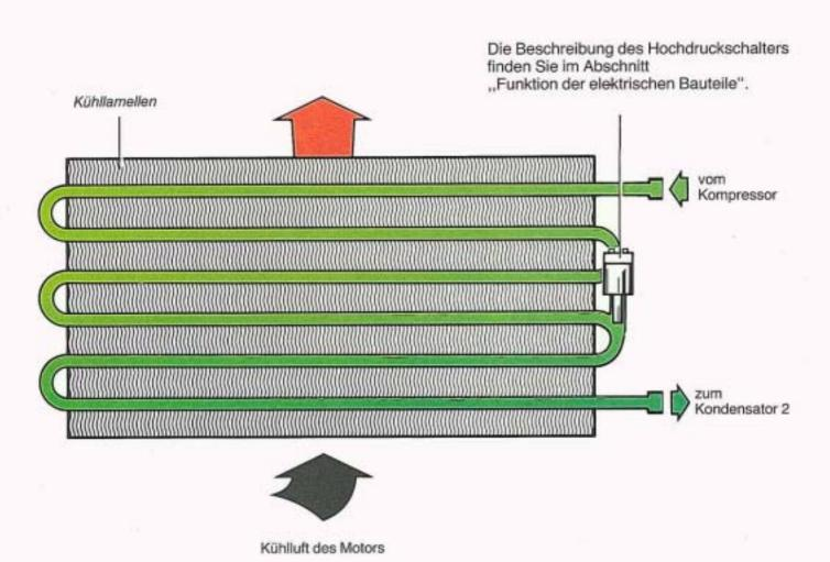
Der überhitzte Kältemitteldampf strömt durch die Rohrschlangen der Kondensatoren und gibt Wärme – bei unverändert hohem Druck – über die Kühllamellen an die Kühlluft des Motors ab. Der Kältemitteldampf kühlt ab und wird flüssig.
