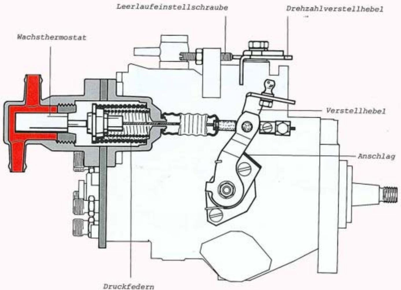
Mit zunehmender Erwärmung des Kühlmittels dehnt sich der Wachsthermostat aus.
