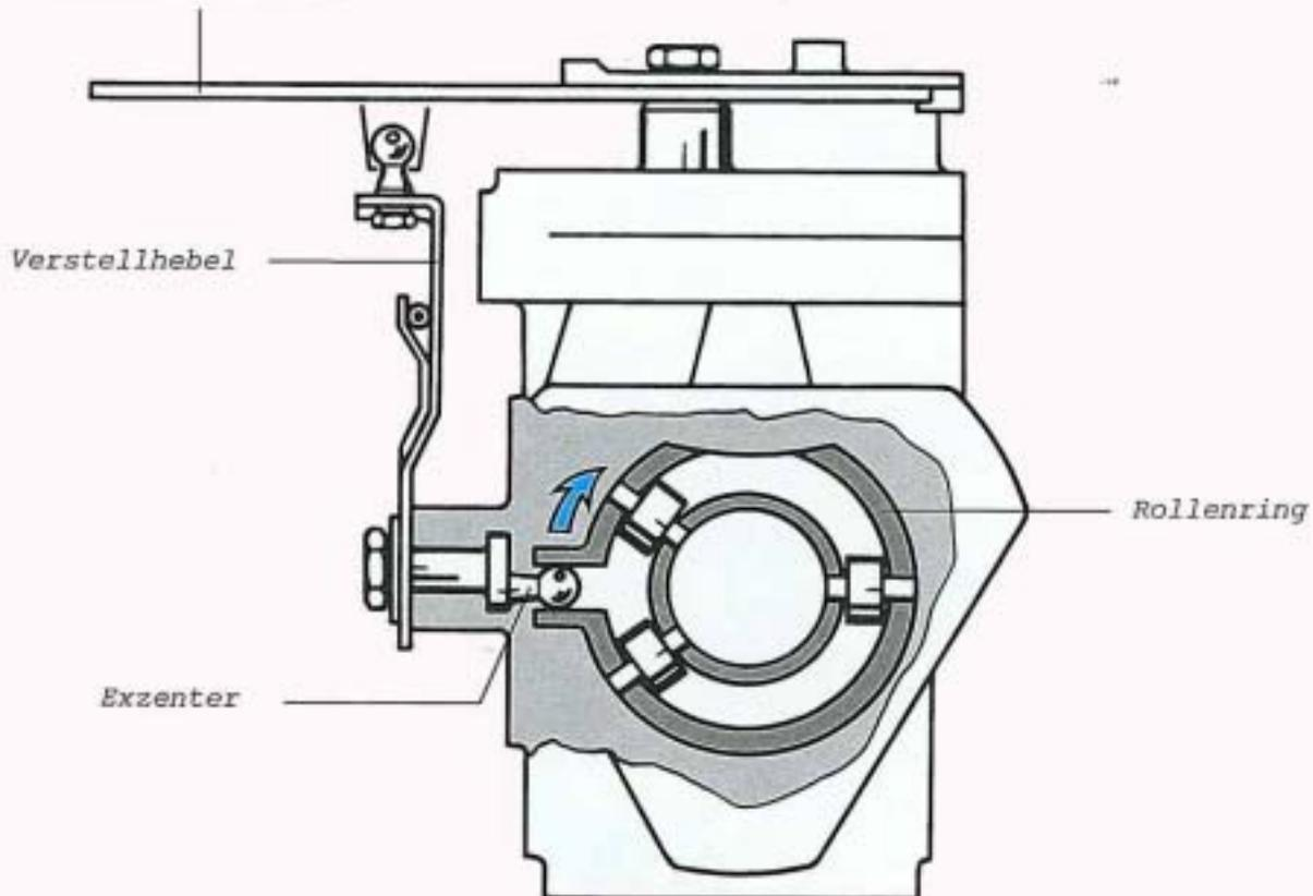
Nach kurzer Betriebszeit heizt das Kühlmittel den Wachsthermostaten auf. Die Druckfedern werden zusammengedrückt. Der Verstellhebel kann bis zum Anschlag nach rechts ausweichen. Der Rollenring geht in die Ausgangsstellung zurück.
