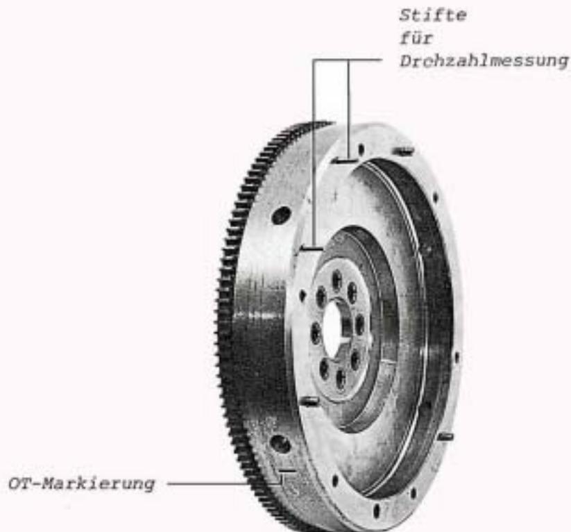
Bei dem 5-Zylinder-Dieselmotor kann die Drehzahl auch
