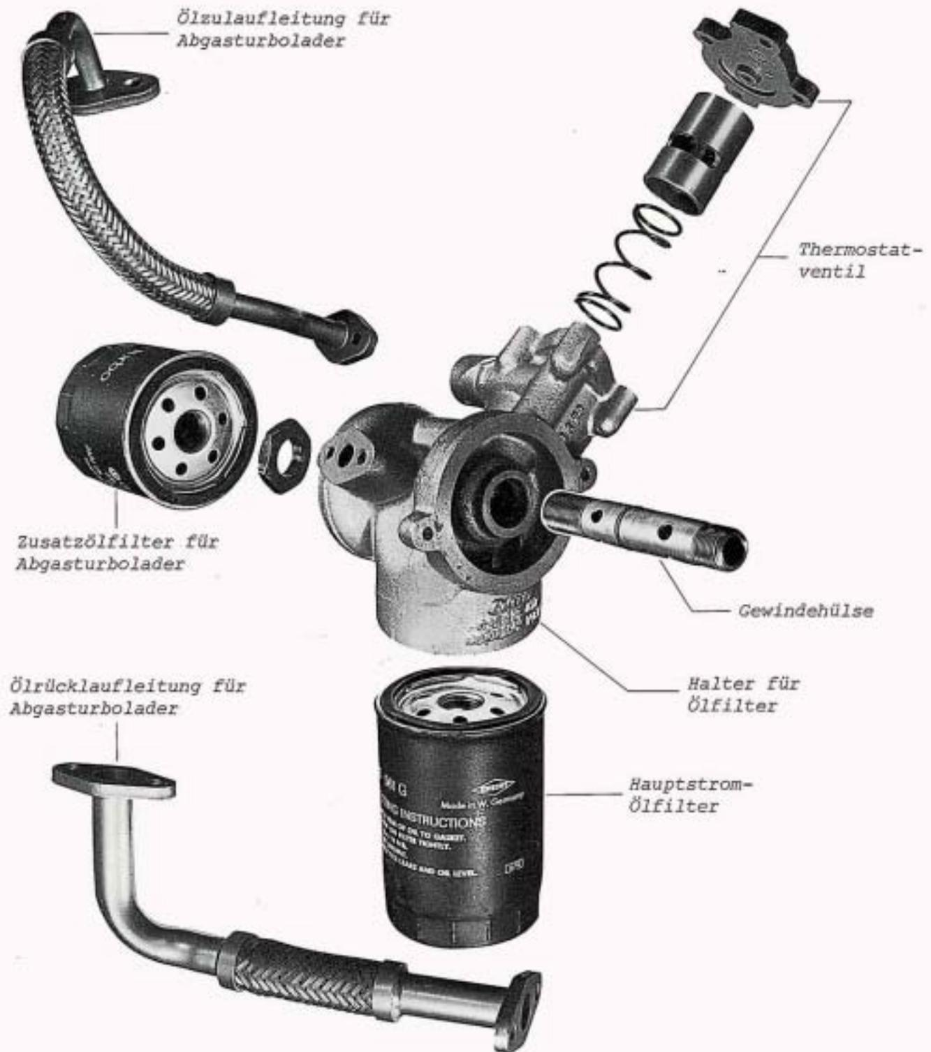
Die Ölfilter sind mit einem Halter am Zylinderkurbelgehäuse befestigt. Das Thermostatventil ist in den Halter eingebaut. Die Ölzulaufleitung für den Abgasturbolader ist am Halter, die Ölrücklaufleitung für den Abgasturbolader am Zylinderkurbelgehäuse angeschraubt.
