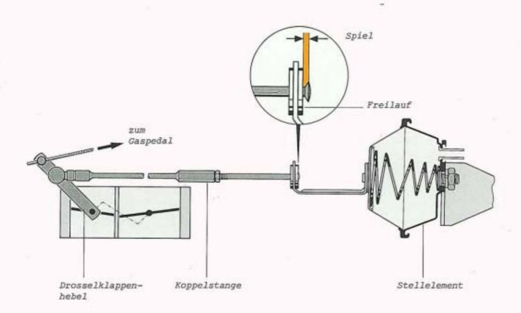
In Leerlaufstellung muß zwischen Anschlagteller und Freilauf ein bestimmtes Spiel vorhanden sein, damit die Drosselklappe bzw. der Regelhebel der Einspritzpumpe am Anschlag anliegt.
