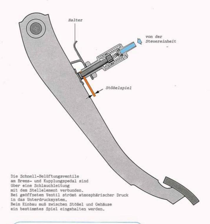
Die Einstellung des Stößelspiels erfolgt am Gewinde des Schnell-Belüftungsventils.
