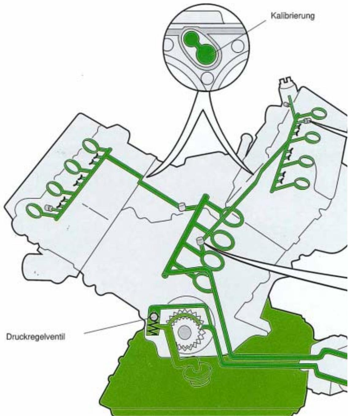
Die **Rückschlagventile** sind im Beruhigungsraum der Kurbelgehäuseentlüftung untergebracht. Sie verhindern das Leerlaufen der Ölkanäle und der hydraulischen Tassenstößel. Ein Wiederholstart-Klappen wird so vermieden.
