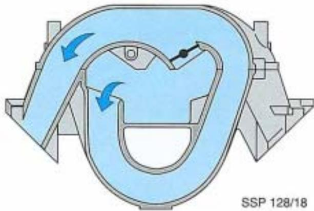
Die Umschaltklappen im Schaltsaugrohr sind geschlossen. Lange Ansaugwege mit engem Querschnitt erzeugen eine hohe Strömungsgeschwindigkeit.
