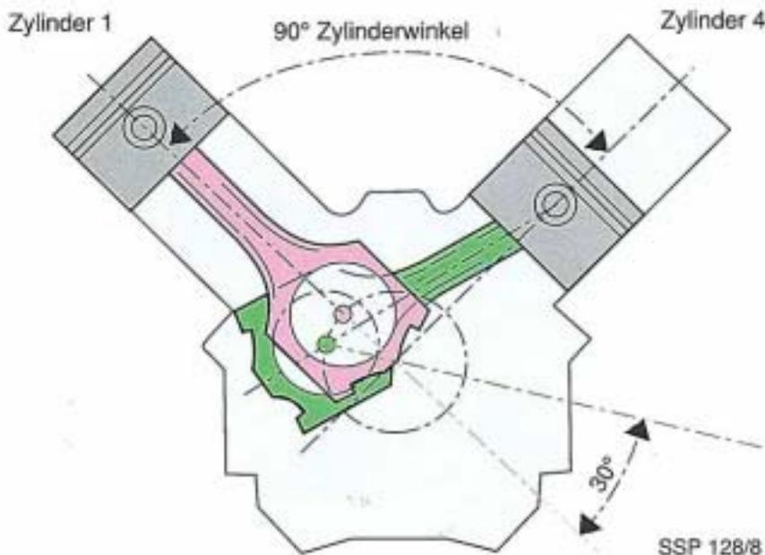
**Stellung des Kurbelzapfens von Zylinder 4 bei OT von Zylinder 1.**
