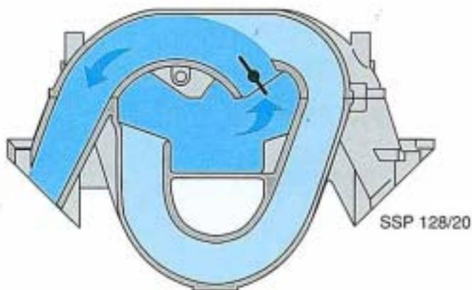
Die Umschaltklappen im Schaltsaugrohr sind geöffnet. Kurze Ansaugwege mit großem Querschnitt bewirken ein großes Luftvolumen und gute Füllung.
