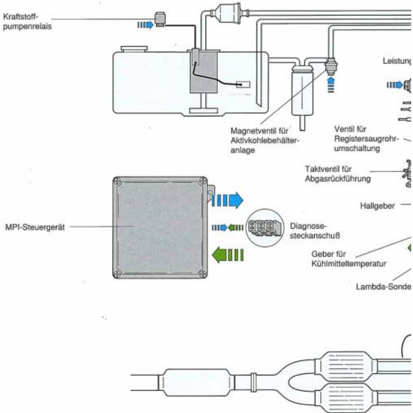
Die Sensorsignale sowie die Sensoren- und Aktorenstromkreise werden von der Eigendiagnose überwacht.
