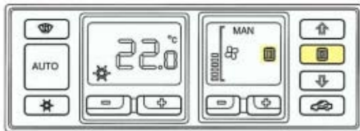
Luftverteilung zu den Schalttafel ausströmern
