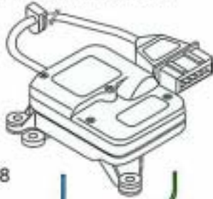
Stellmotor - Temperaturklappe mit Potentiometer G92
