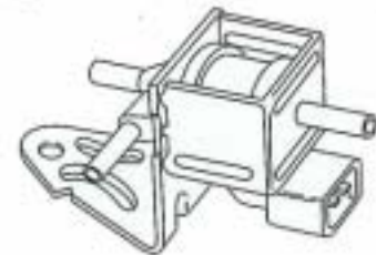
Zweiwegeventil für Frischluf-/Umluftklappe
