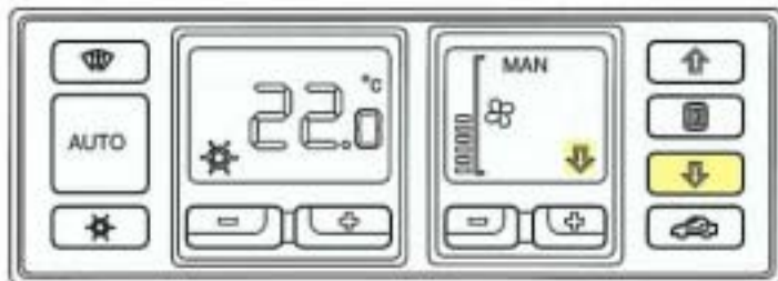
Luftverteilung in den Fußraum
