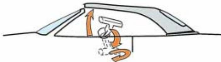
2. – Zentralverschluß am Dachrahmen entriegeln und Verdeck vorn anheben
