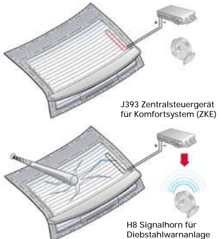
J393 Zentralsteuergerät für Komfortsystem (ZKE)
