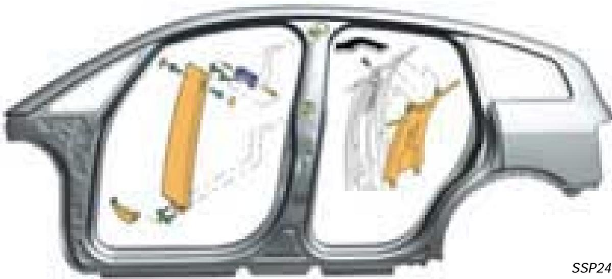
Erstmalig im Automobilbau kommt ein einteiliger Seitenwandrahmen aus Aluminium zum Einsatz.
