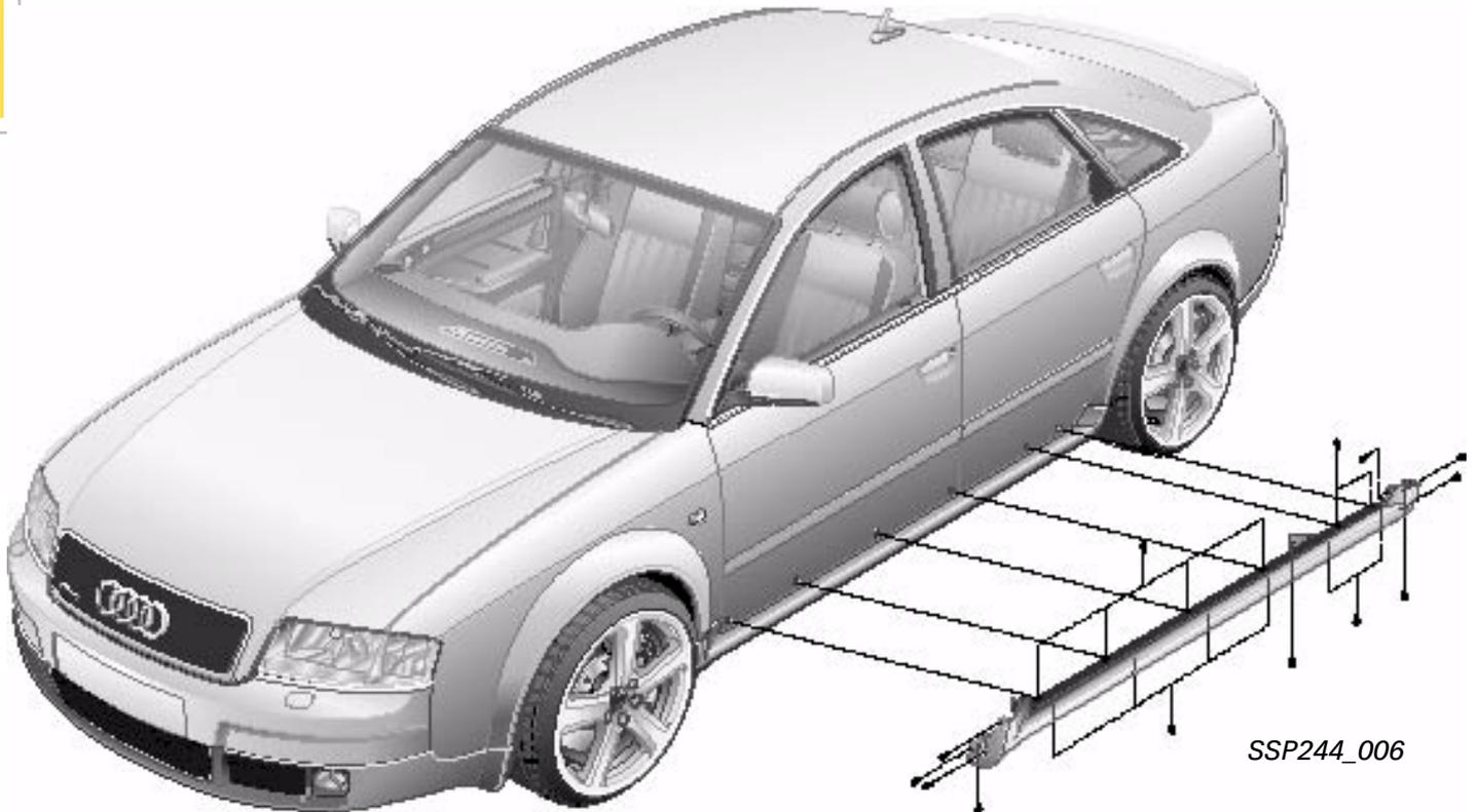
Die Anordnung und Befestigung des neuen seitlichen Schwellerabschlusses erfolgt mittels Schrauben im Unterbodenbereich und jeweils am Kotflügel vorn und hinten; am Schweller oben mit Kunststoffstopfen.
