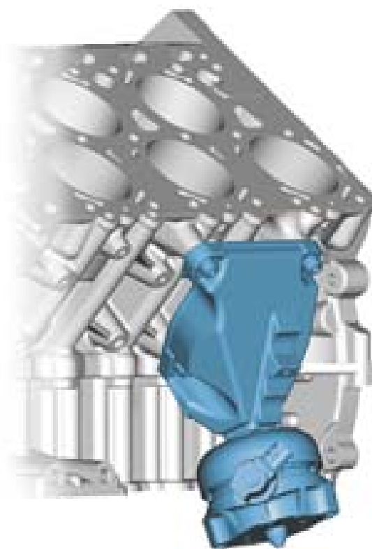
Motorlager Zylinderbank 2 mit Magnetventil N144
