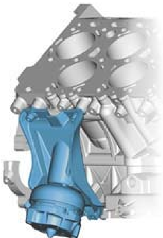
Опора первого ряда цилиндров с электромагнитным клапаном N145
