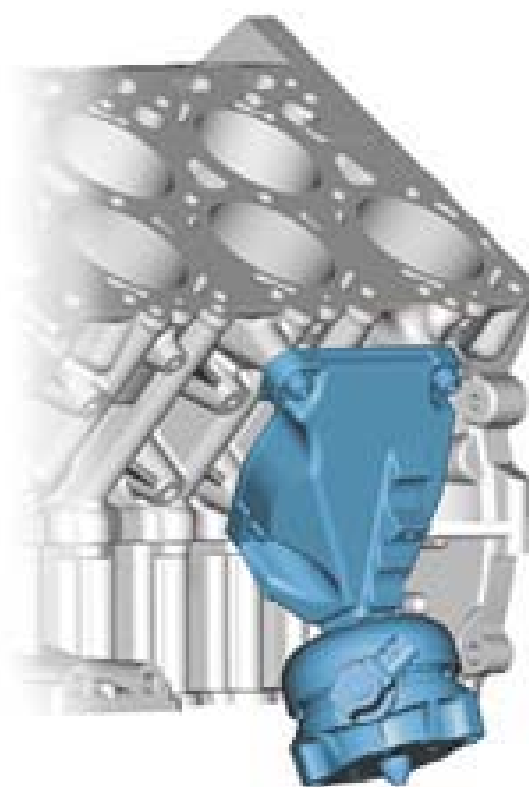
Опора второго ряда цилиндров с электромагнитным клапаном N144
