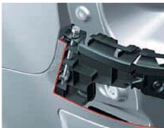
La junta cero entre el parachoques y la pieza lateral no se fijan con una unión roscada, sino mediante una unión por clip.
