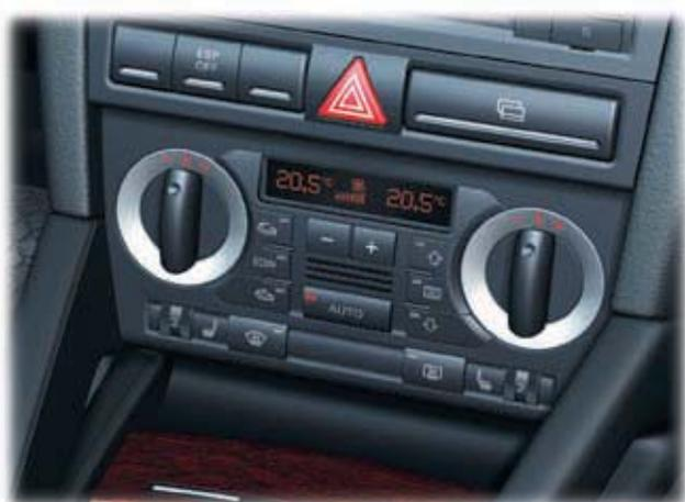
La unidad de control para Climatronic J255 es posible en las variantes con y sin calefacción de los asientos, así como una cavidad para radio de altura 1DIN o 2DIN.
