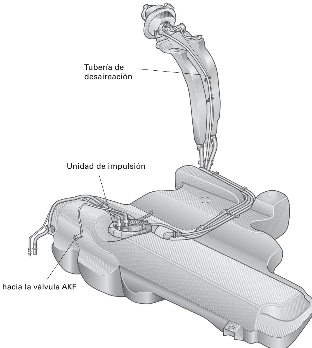
La tracción quattro® hace necesario disponer el depósito como sistema de doble cámara. En la segunda cámara del depósito está integrada una bomba de chorro aspirante, así como un segundo transmisor de nivel del depósito.
