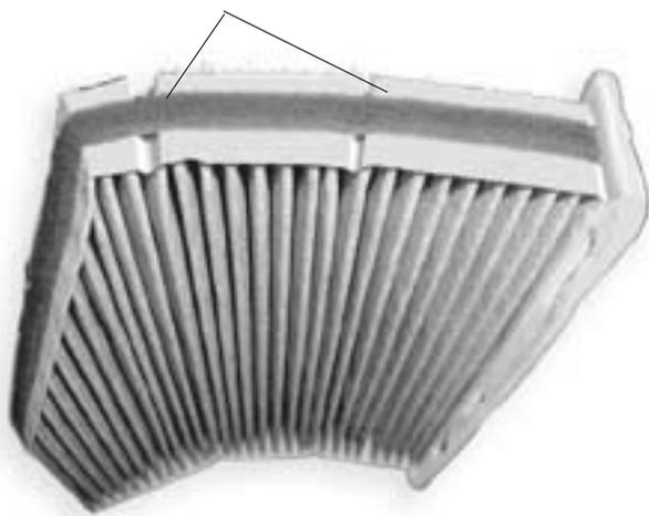
Filtro de polen con los puntos de doblado previstos en el área del filtro. Estos facilitan su sustitución en la zona difícilmente accesible del espacio reposapiés.
