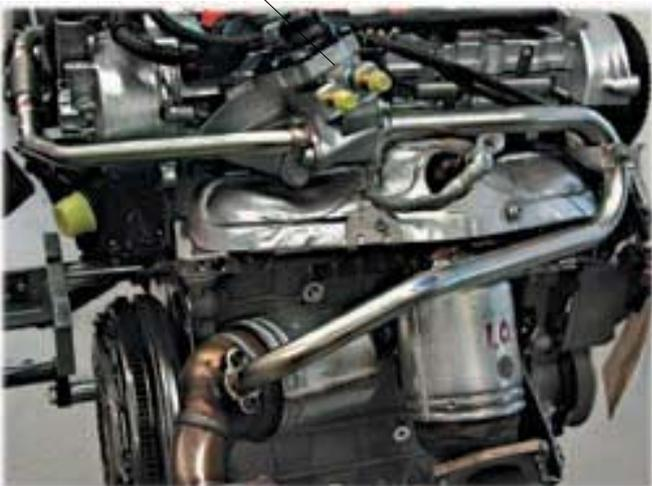
La válvula de recirculación de gases de escape se aplica como válvula de chapaleta giratoria, igual que en el A4.
