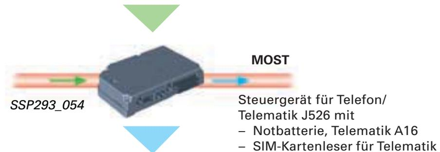
Das Steuergerät für Telefon/Telematik steuert folgende Verbraucher an:
