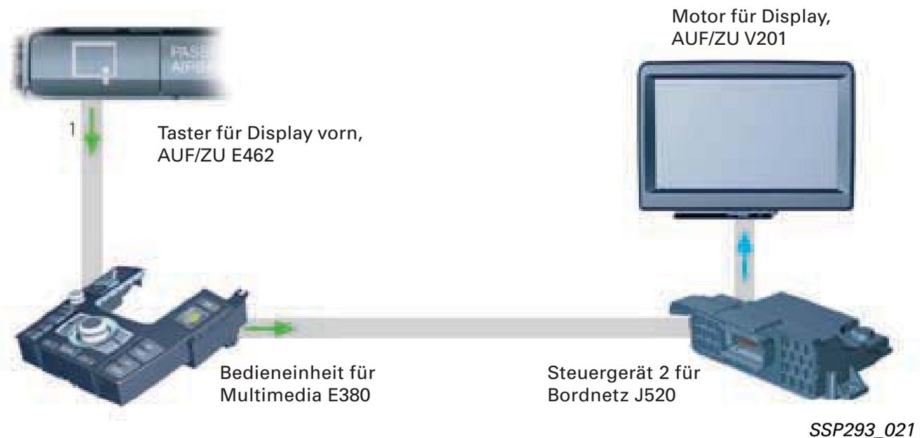
Das Einklappen des Displays durch das Betätigen des Tasters für Display vorn, AUF/ZU E462 erfolgt nur durch die Datenübertragung mit Hilfe der Bussysteme.
