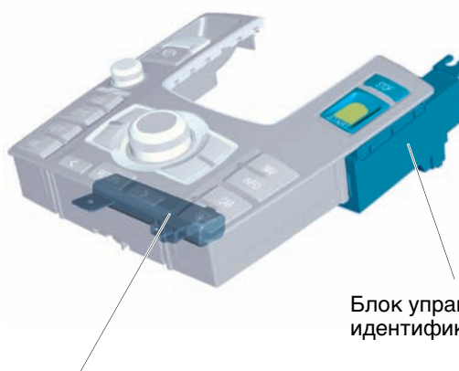
Антенна 1 системы санкционирования доступа и пуска двигателя в салоне автомобиля R138
