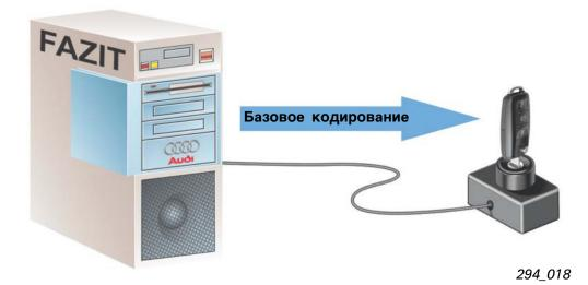
Дополнительно заказанные ключи содержат базовую кодировку из базы данных FAZIT. Если автомобилю присвоен «новый код», то:
