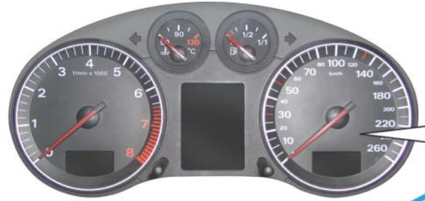
J285 - Steuergerät mit Anzeigeeinheit im Schalttafeleinsatz
