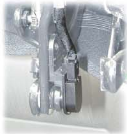
F295 Interruptor de bloqueo de la capota (cerrado) F294 Interruptor de bloqueo de la capota (abierto)
