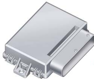
Steuergerät für elektromechanische Parkbremse J540 im Kofferraum rechts
