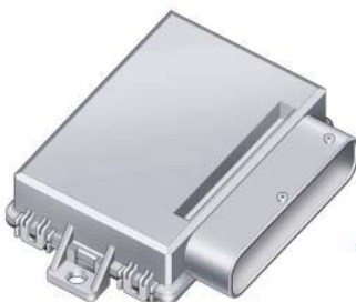
Блок управления электромеханическим стояночным тормозом J540, расположен в багажном отсеке справа
