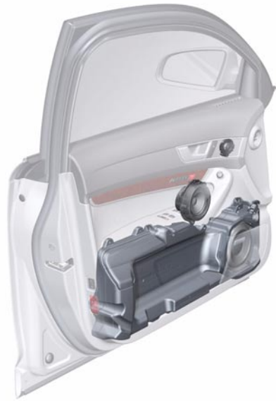
Audi A6 '05 Fronttür mit Subwoofer und Lautsprechereinbauorten
