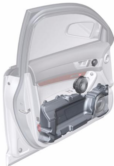
Audi A6 2005: puerta delantera con subwoofer y montaje de altavoces
