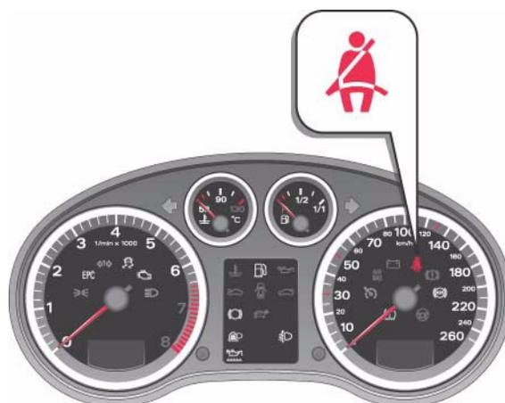
Testigo de aviso de colocación del cinturón de seguridad 332\_007
