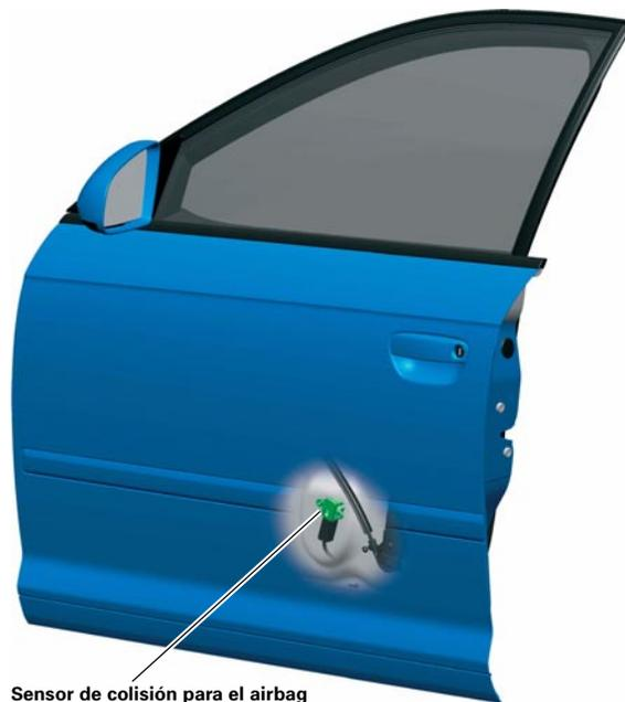
Sensor de colisión para el airbag lateral en la puerta delantera
