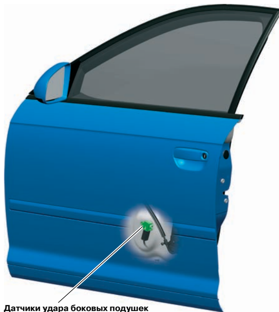
Датчики удара боковых подушек безопасности, установленные в передних дверях
