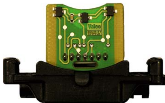
Плата с датчиками Холла, определяющими направление движения и положение двери задка
