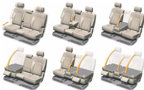
Die easy-entry-Funktion der zweiten Sitzreihe wird durch einen Hebel neben der Kopfstütze betätigt. Die Sitzlehne klappt dabei um einen gewissen Winkel nach vorn. Ebenfalls verschiebt sich die Sitzfläche in Fahrtrichtung.
