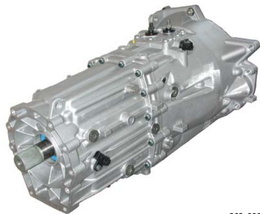
6-Gang-Schaltgetriebe 08D/ ML400 (Einsatz voraussichtlich 2. Quartal 2006)
