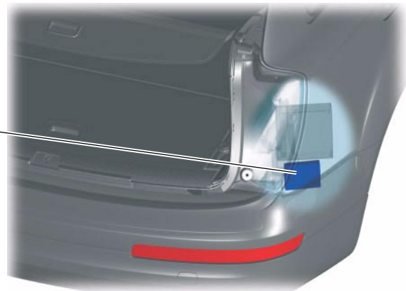
Einbauort der Antenneneinleseeinheit für schlüssellose Zugangsberechtigung J723
