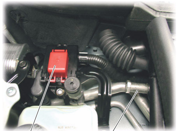
Terminal positivo para arranque auxiliar
