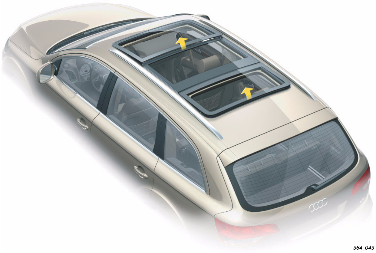
Techos de cristal 1 y 3 en posición deflectora
