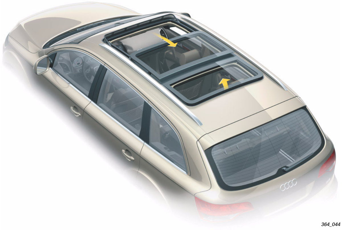
Techo de cristal 1 abierto y techo de cristal 3 en posición deflectora
