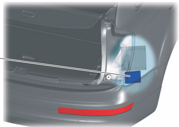
Localización de la unidad lectora de antena para autorización de acceso sin llave J723
