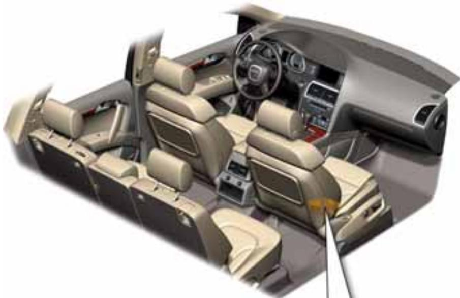
Bordnetzsteuergerät 2 J520
