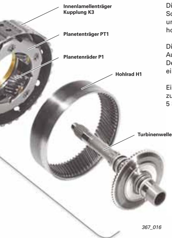
Die Besonderheit des Lepelletier-Planetenradsatzes besteht darin, die Sonnenräder und den Planetenträger des Ravigneaux-Radsatzes mit unterschiedlichen Drehzahlen anzutreiben. Dadurch ergibt sich eine hohe Anzahl von Übersetzungsmöglichkeiten.
