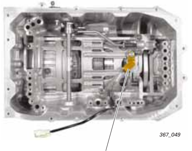
Sensor de régimen de salida del cambio G195
