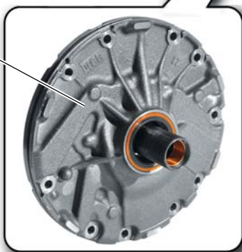
Насос ATF (снят)
