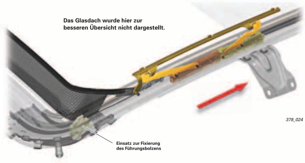
Zum Öffnen des Glasdeckels aus der Position – Dach ausgestellt – wird die obere Mechanik durch Freiwerden der vorderen Führungsbolzen, aus dem tiefer liegenden Einsatz der Führungsschiene angehoben und in eine waagerechte Position gebracht. In dieser Lage wird die Führung mit der Ausstellmechanik nach hinten, in Richtung Dach öffnen, verschoben. Dabei wird der vorgespannte Windabweiser freigegeben und stellt sich auf.
