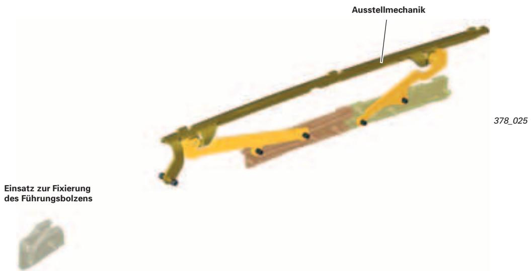
Zur übersichtlicheren Darstellung der Kulissenbewegungen werden nur die innenliegenden Kulissenbahnen der Führungen vorn und hinten mit der Ausstellmechanik dargestellt.
