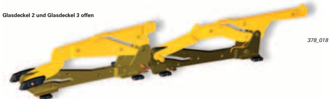
Der Glasdeckel 2 steht über Glasdeckel 3 – beide Glasdeckel sind geöffnet. Der Schließvorgang der Glasdeckel verläuft analog „Glasdeckel öffnen“ in umgekehrter Reihenfolge.
