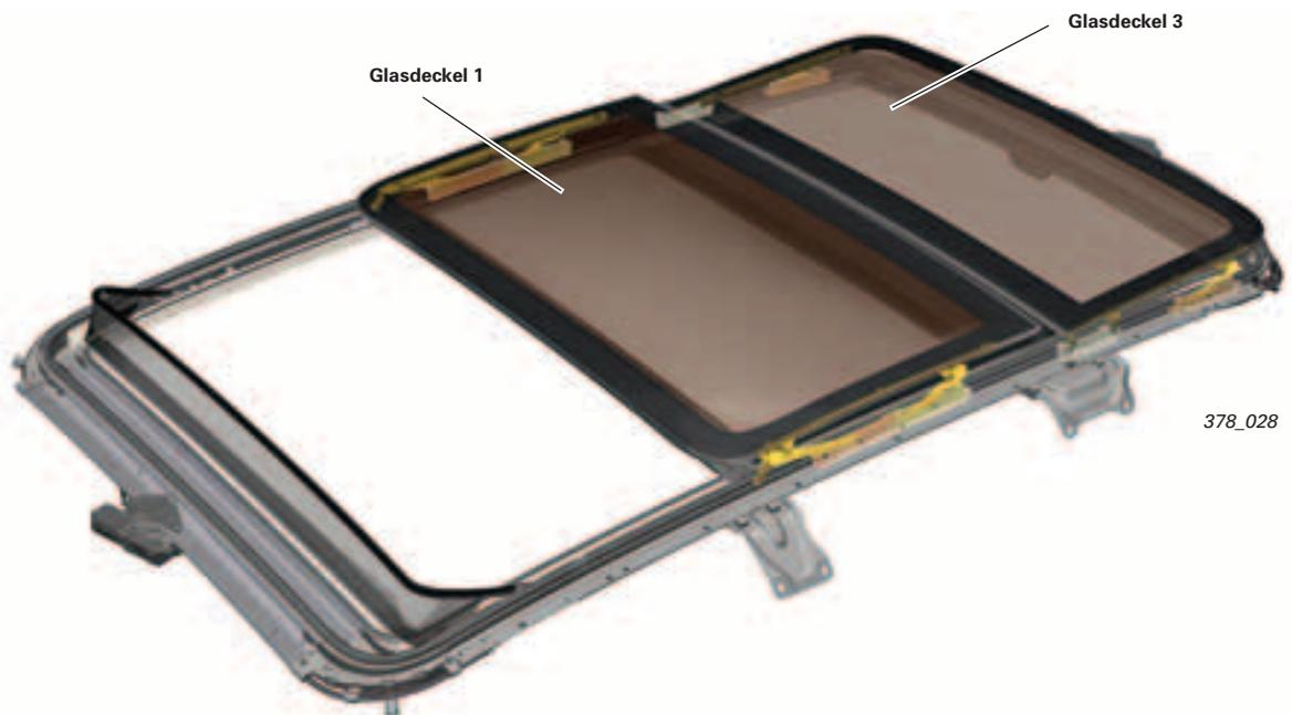
Zum kompletten Öffnen des Glasdeckels 1 werden die Führungen links und rechts außen am Glasdeckel 2 vorbei nach hinten verschoben. Der Schließvorgang des Glasdeckels verläuft analog „Glasdeckel öffnen“ in umgekehrter Reihenfolge.
