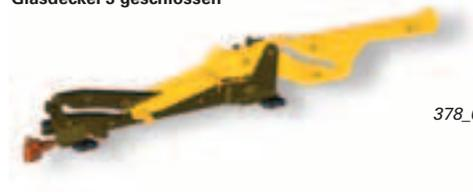
Bei geschlossenem Dach befinden sich die Führungen links und rechts in den Führungsschienen vorn auf Anlage und somit in Ruhestellung.
