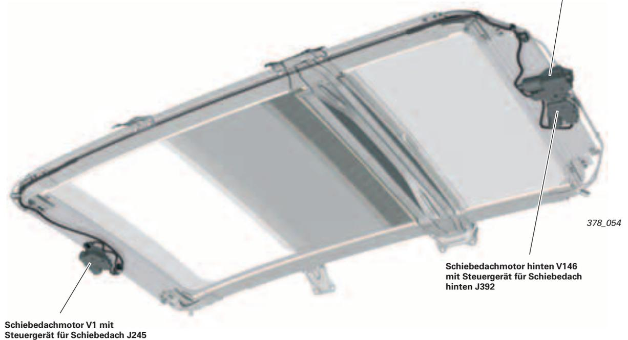
Das Zentralsteuergerät 2 für Komfortsystem J773 ist über den LIN-Datenbus mit den Steuergeräten des open sky Systems des Audi Q7 verbunden. Deshalb ist dieses System im Gegensatz zu dem open sky Systemen des Audi A2 und Audi A3 Sportbacks auch diagnosefähig.
