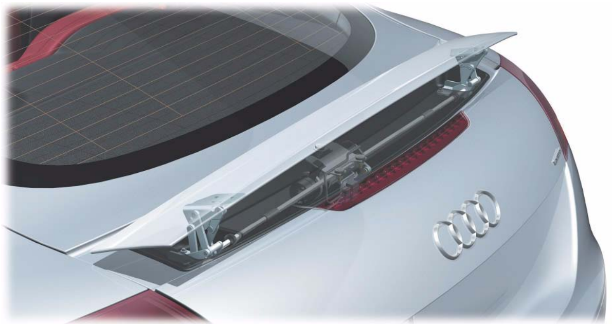
Alerón posterior en la posición final superior (emergido)
