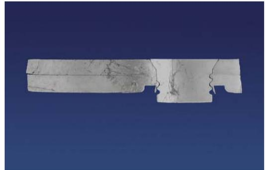
Schliffbild einer Vollstanzniet Verbindung
