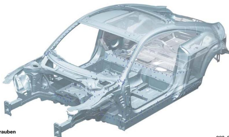
Einsatzbereiche Flow Drill Schrauben
