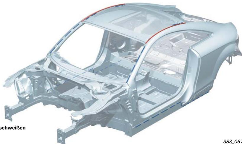
■ Einsatzbereiche Laserstrahlenschweißen
