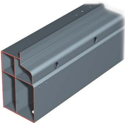
Perfil de estribera Audi TT Perfil extrusionado de cuatro cámaras
