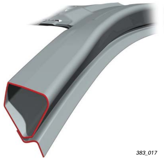
Pilar A Audi A8 Perfil extrusionado de una cámara
