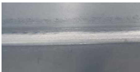
Costura láser antes (arriba) y después (abajo) del proceso de cepillado
