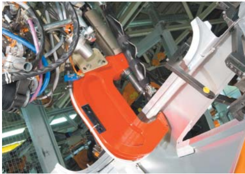
Proceso de remachado con estampado pasante en la producción 383_061
