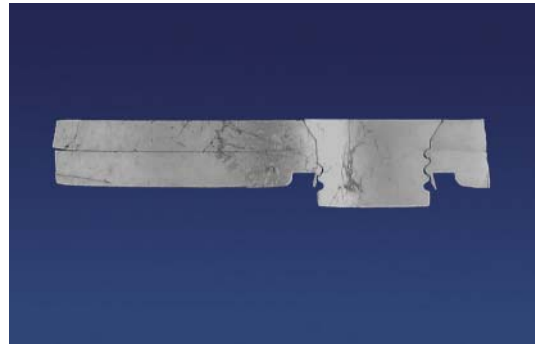
Imagen de una sección rectificada con unión mediante remache con estampado pasante 383_073
