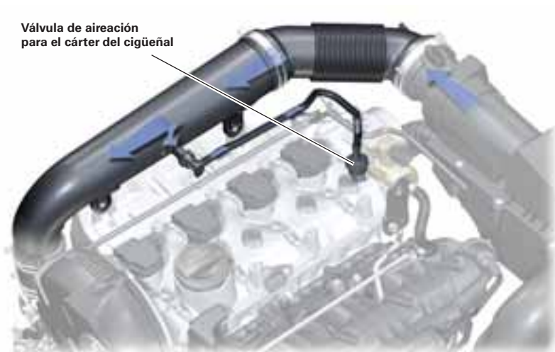
Válvula de aireación para el cárter del cigüeñal, en vista seccionada
