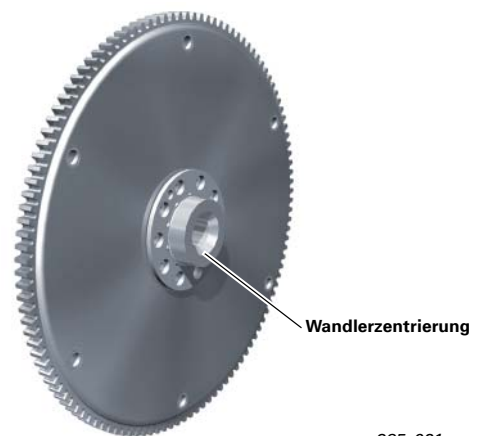
Mitnehmerscheibe (mit der Kurbelwelle verschraubt)
