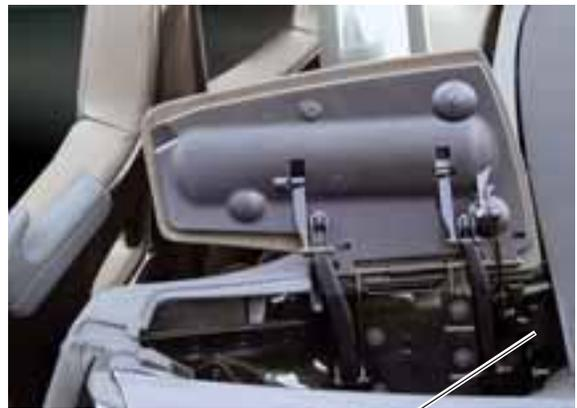
Motor für Verdeckklappe V383 mit
