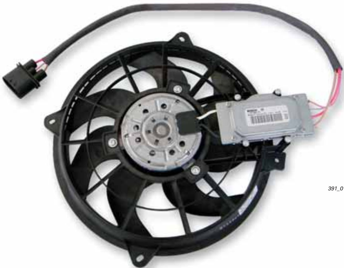
Ventilador del radiador V7 con unidad de control para ventilador del radiador J293
