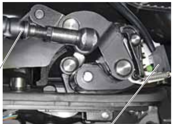
Conmutador de bloqueo de la capota cerrada F295 Elemento superior derecho del cierre
