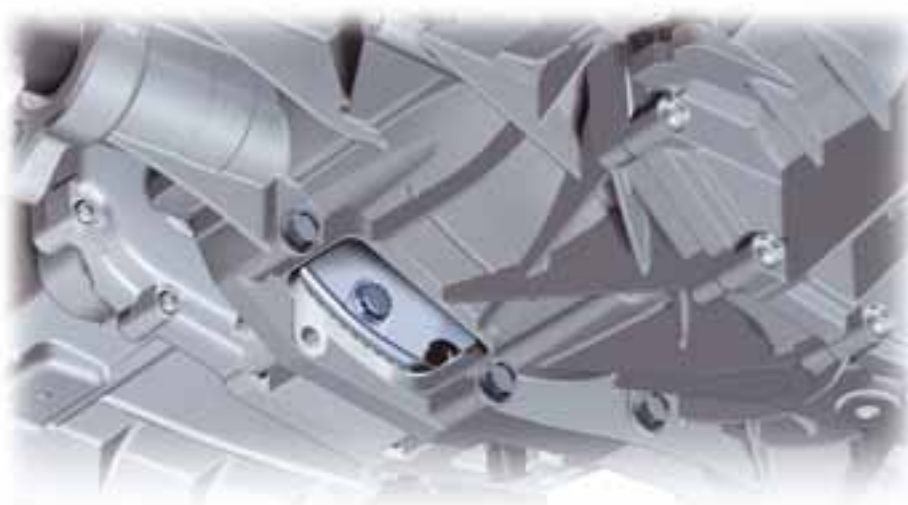
Serviceöffnung mit Abdeckung (Ansicht von unten)
