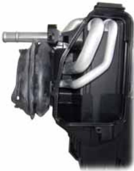
Grupo de tuberías de serie, tomando como ejemplo el evaporador
