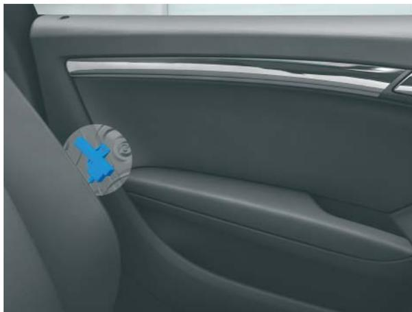
Verbauort der Antenne R200 in der Fahrertür
