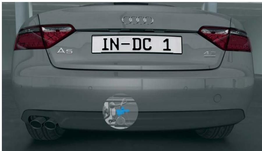
Verbauort der Antenne R137 im Kofferraum
