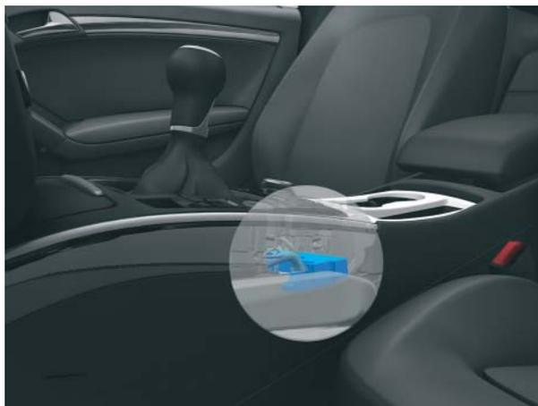
Verbauort der Antenne R138 in der Mittelkonsole
