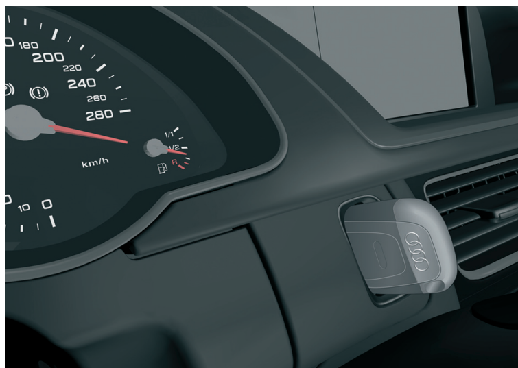
Ключ, вставленный в модуль электронного замка зажигания
