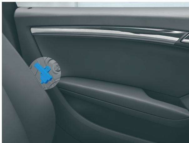
Место установки антенны R200: в двери
