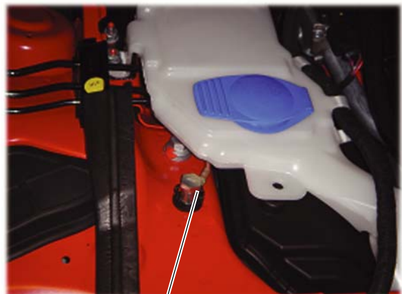
Terminal de masa en la caja de aguas
