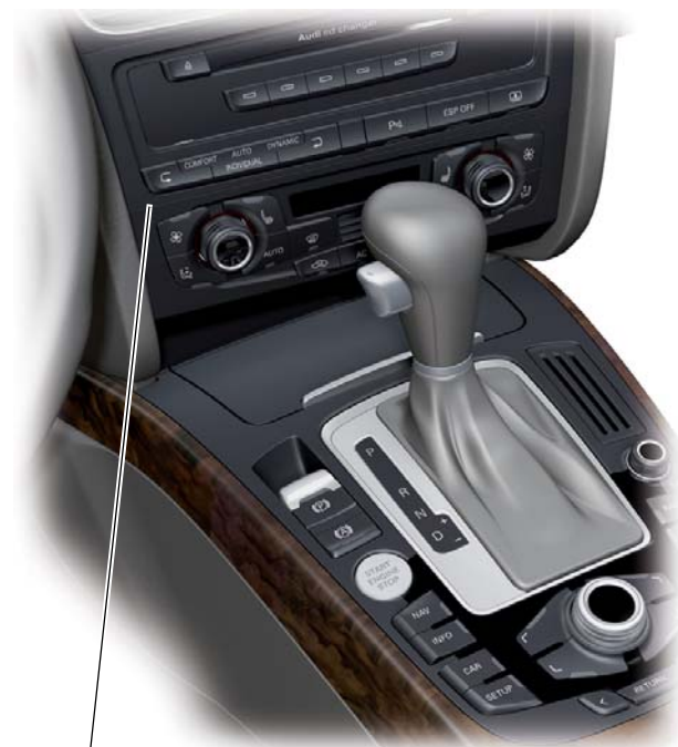
Панель управления Audi drive select модуль переключателей Charisma E592
