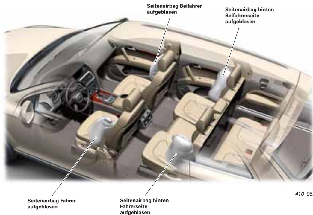
Bei den Vordersitzen sind die Airbagmodule außen in den Sitzlehnen verbaut. Bei den hinteren Sitzen können die Airbagmodule außen in den Sitzlehnen oder auch in der Seitenverkleidung verbaut sein.
