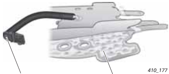
Sensor de presión para detección de ocupación de asiento
