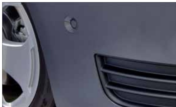
Место установки бокового правого ультразвукового датчика парковочного автопилота
